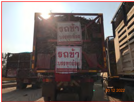
ภาพที่ 2.2-38 การติดตั้งสัญญาณท้ายรถบรรทุกอ้อย
